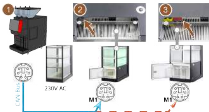
図: コーヒーマシンの周辺機器へのCANバス接続の概要
