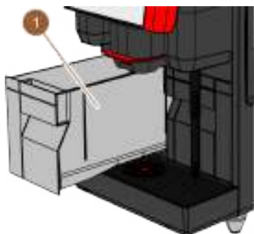
図: 内部の飲料水タンク
